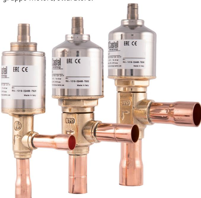
Per tutti e tre i "Body Size" la brasatura deve essere eseguita accuratamente con una lega a basso punto di fusione; durante la brasatura occorre prestare attenzione a non dirigere la fiamma verso la valvola, sia corpo che motore, proteggendola eventualmente con uno straccio bagnato.
